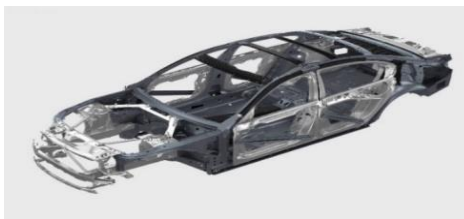
Gambar 2.11. Konstruksi bodi menyatu ( https://www.serayamotor.com )
