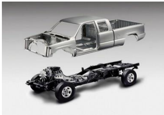
Gambar 2.10. Konstruksi bodi terpisah ( https://www.serayamotor.com )
