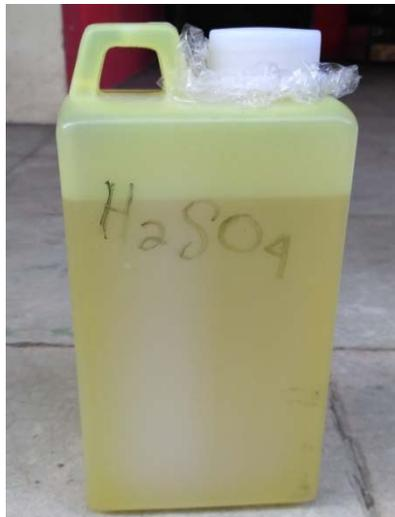
**Gambar 3.18 Asam Sulfat ( $H_2SO_4$ )**
