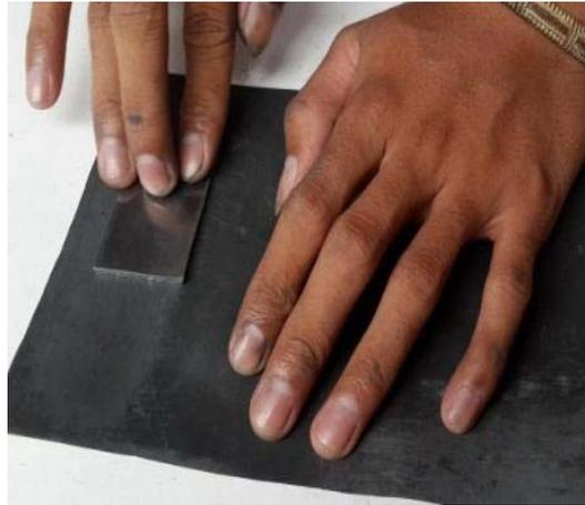
**Gambar 3.28 Proses Pengamplasan Spesimen**
