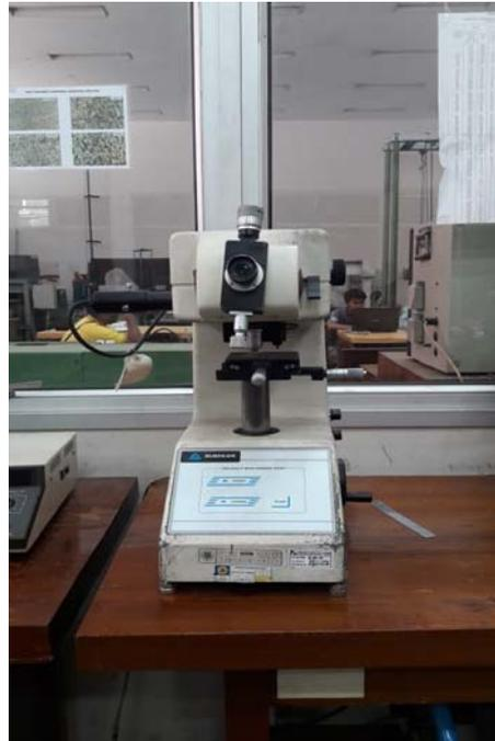
**Gambar 3.38 alat pengujian kekerasan**
