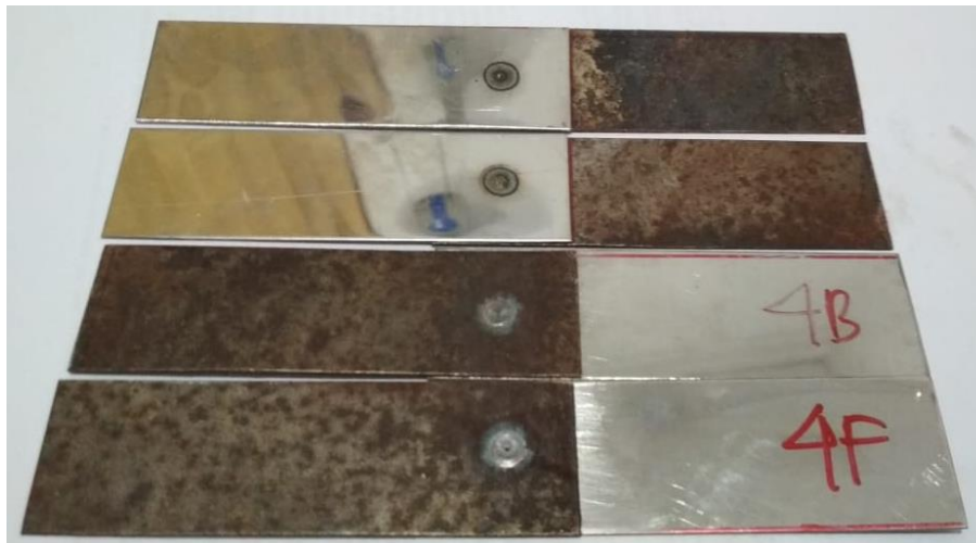
Gambar 4.2 Hasil percobaan pengelasan spot TIG
