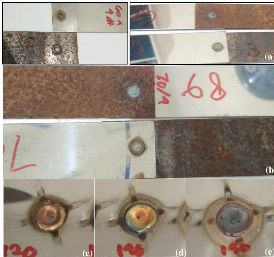
Gambar 4.1 (a) Percobaan 60 A, (b) 70 A, (c) 120 A, (d) 140 A dan (e) 150 A
