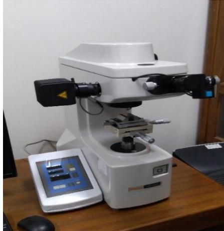
Gambar 3. 3 Alat uji kekerasan *Vickers*
