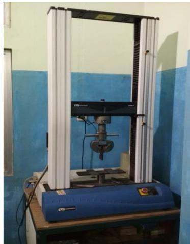
Gambar 3. 2 Alat uji tarik tipe Instron 3367
