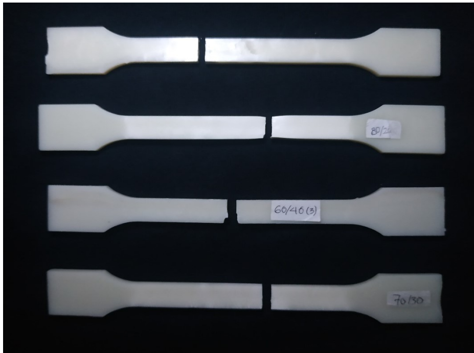
Gambar 4.13 Spesimen hasil pengujian tarik
