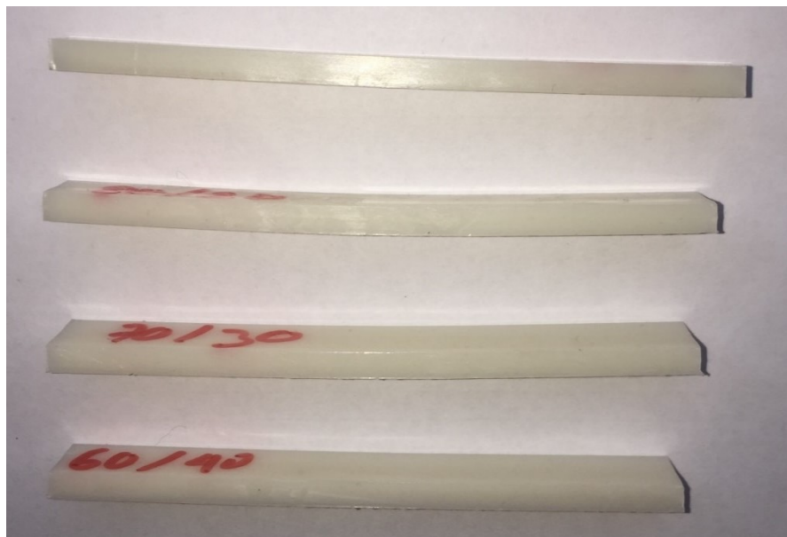
Gambar 4.17 spesimen pengujian thermal HDT
