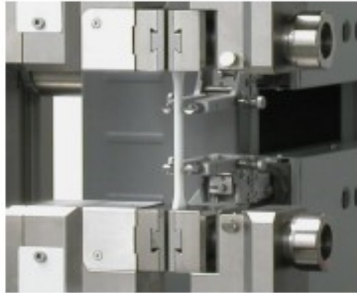
Gambar 2.3 Pengujian Tarik ISO 527-1
