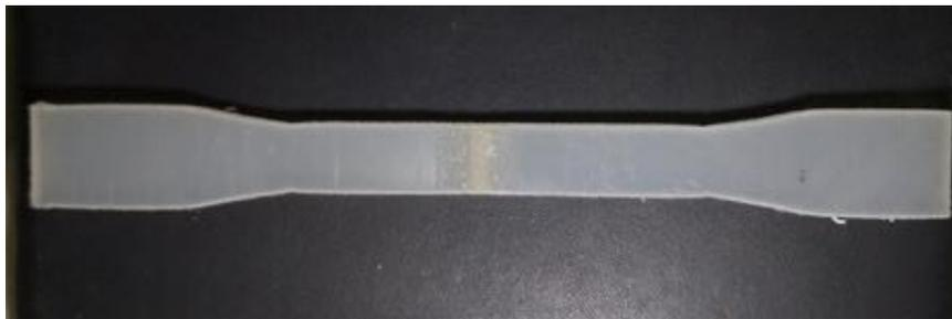
**Gambar 3.17** Hasil pemotongan spesimen untuk uji tarik
