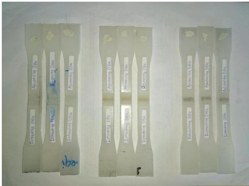
**Gambar 3.18** Hasil semua pemotongan spesimen uji tarik
