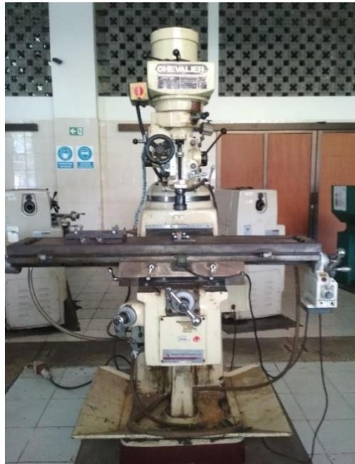
**Gambar 3.2** Mesin Milling Vertikal
