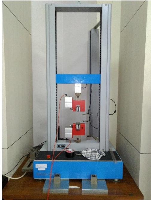
**Gambar 3.3** Mesin uji tarik
