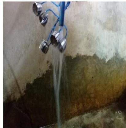
Gambar 3.7 pelapisan krom      pembilasan dengan air mengalir
