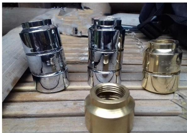
Gambar 3.8 Hasil *plating* dan sebelum *plating*
