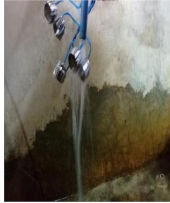
Gambar 3.6 pelapisan nikel      pembilasan dengan air mengalir
