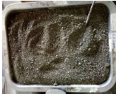
Gambar 3.17 Agregat halus (pasir kali progo)
