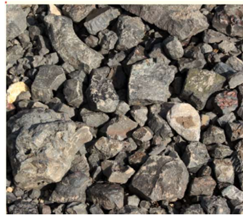
Gambar 3.20 Limbah baja ( Steel slag )
