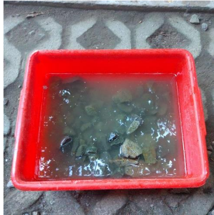
Gambar 3.9 Pencucian Agregat Kasar Untuk Benda Uji Balas Bersih
