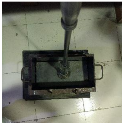
Gambar 3.12 Proses Pemadatan Lapisan Balas
