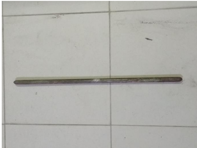
Gambar 3.5 Batang besi penusuk/ pematat beton segar
