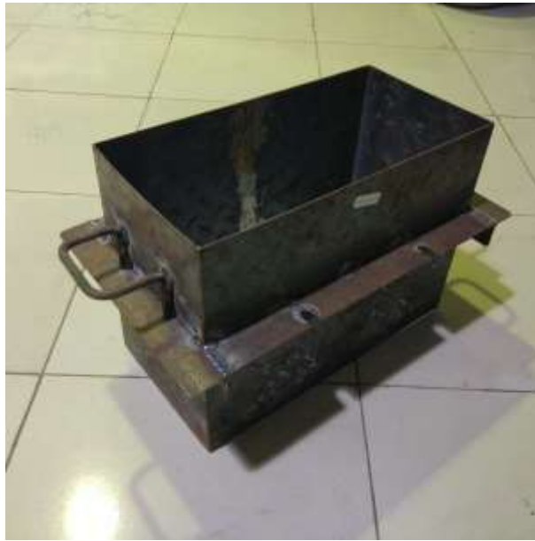
Gambar Box Cetakan Benda Uji
