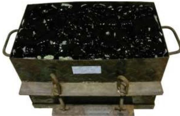
Gambar 3. 12 Benda Uji dengan Campuran Aspal.
