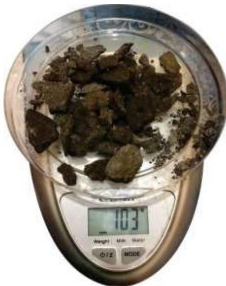
Gambar 3. 16 Penimbangan Agregat Setelah di Oven.
