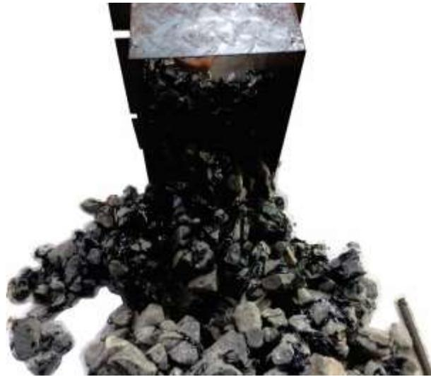
Gambar 3. 14 Pembongkaran Benda Uji
