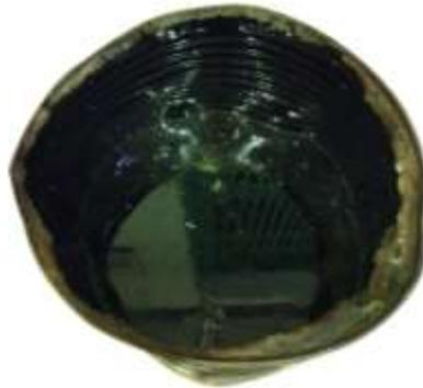
Gambar 3. 8 Aspal Padat Penetrasi 60/70.
