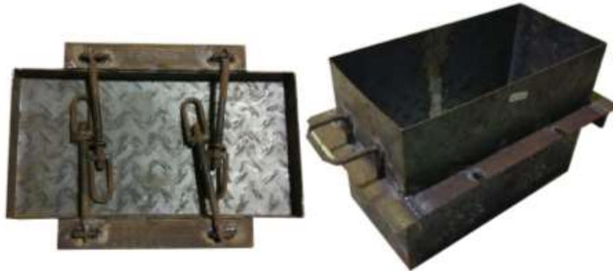
Gambar 3. 2 *Box* Cetakan dan Alas *Box* Cetakan Benda Uji.
