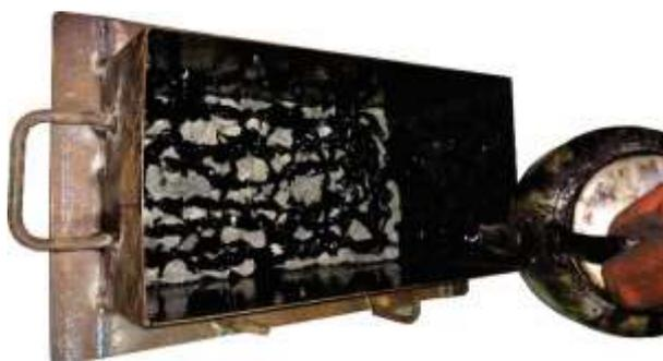
Gambar 3. 11 Penuangan Aspal pada Benda Uji.
