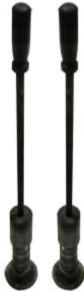
Gambar 3. 4 Alat Penumbuk Benda Uji dengan Beban Sebesar 4,5 Kg
