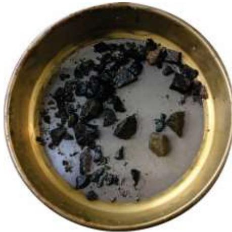
Gambar 3. 15 Agregat Lolos Saringan  $\frac{3}{4}$  Setelah Pencucian
