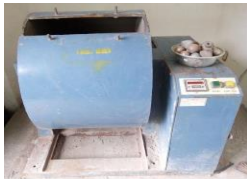
Gambar 3.7 Mesin Abrasi Los Angeles
