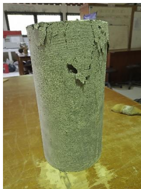
Gambar 30 Beton setelah dilakukan uji tekan
