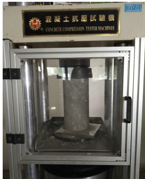
Gambar 3.10 Benda uji pada mesin Compression Testing Machine
