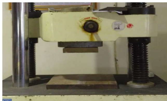
Gambar 3.13 Pelat besi landasan dan pelat landasan penekan benda uji
