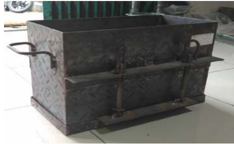
Gambar 3.2 Box cetakan benda uji
