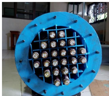
Gambar 4.7. Susunan Kapsul PCM di dalam Tangki
