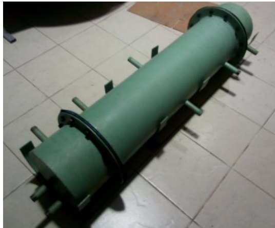
Gambar 4.1. Skema tangki berkapasitas 60 liter
