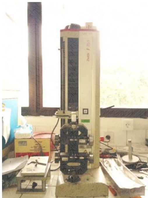
Gambar 3.7 Alat uji tarik dan spesifikasinya
