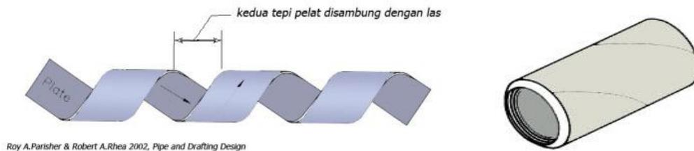
Gambar 2.1. Pipa las spiral (*spiral welding pipe*) sebelum dan sesudah (Parisher & Rhea, 2002)
