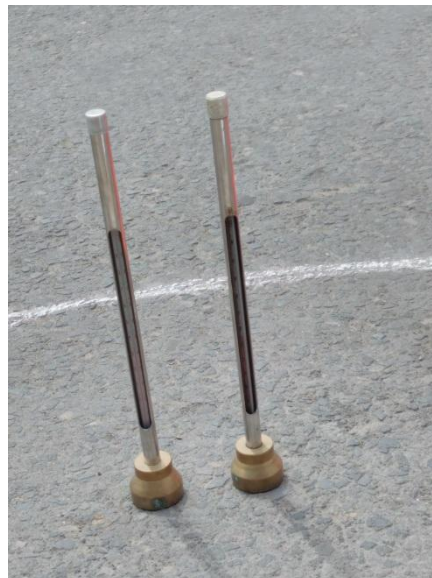
Gambar E.2. Pengujian Temperatur Dengan Menggunakan Alat Thermometer .
