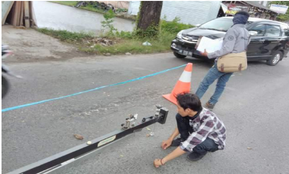
Gambar E.1. Pengujian Lendutan Dengan Menggunakan Alat Benkelman Beam .
