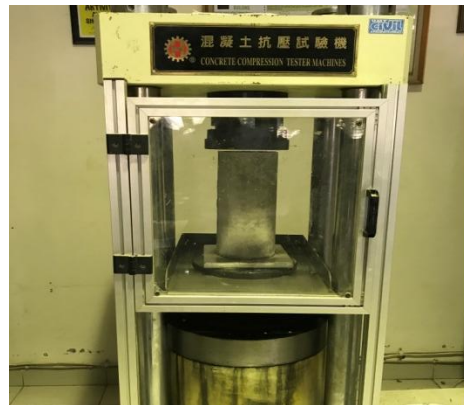
Gambar 24. Pengujian kuat tekan beton
