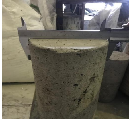
Gambar 22. Pengukuran diameter benda uji silinder
