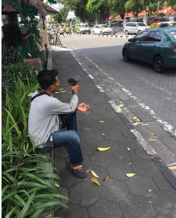
Gambar 3.6 Survei kecepatan kendaraan dengan *speedgun*
