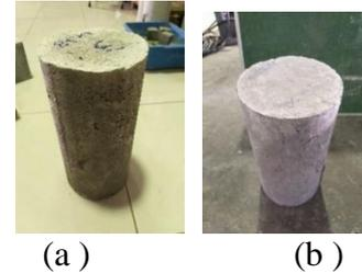
Gambar 5. Beton 10%: (a) sebelum pengujian, (b) sesudah pengujian
