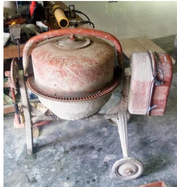
Gambar 3.6. Mixer concrete kapasitas 40 kg
