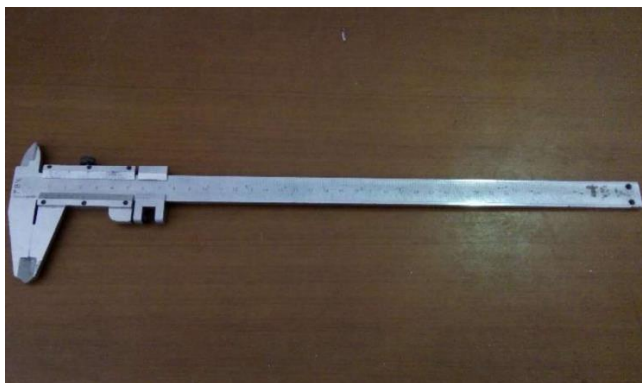
Gambar 3.10. Kaliper dengan ketelitian 0,05 mm
