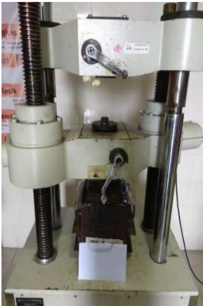
Gambar 5 Proses Pengujian Tekan
