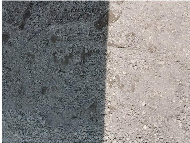
Gambar 3.3 Agregat clereng kelas A
