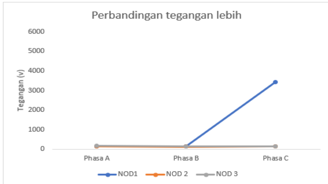
Gambar 4. 31 Grafik tegangan lebih pada NOD1, NOD2, dan NOD3 dengan Arrester terpasang sejauhh 3 m seperti di lapangan
