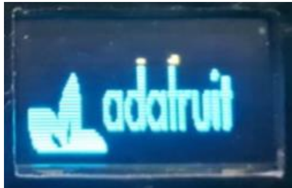
Gambar 3. 15 Hasil Pengujian Modul OLED I2C 0.96”
