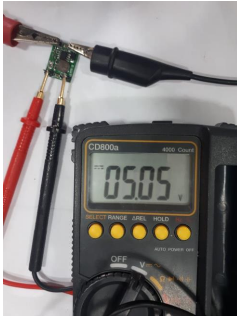
Gambar 3. 17 Hasil Pengukuran Output Modul Step Down DC – DC MP1584
