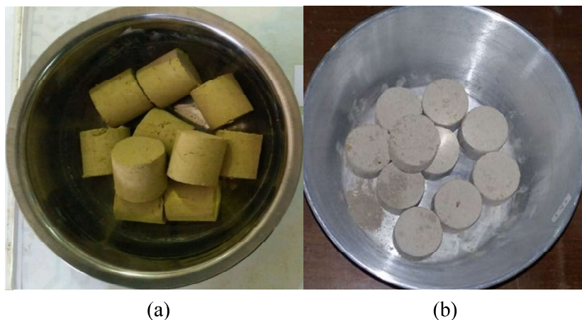
Gambar 3.13 Bentuk Awal Spesimen A Dry Mixed (a) 0% Semen (b) 10% Semen
