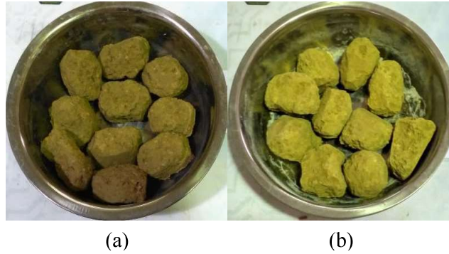
Gambar 3.16 Bentuk Awal Spesimen B Spray Mixed (a) 0% Semen (b) 10% Semen
