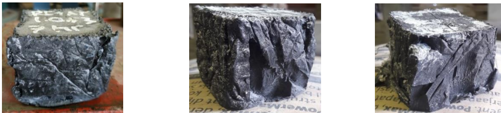
Gambar 3. Benda uji setelah diuji tekan
