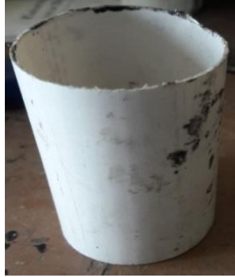
Gambar 3.6 Pipa diameter 4cm dan tinggi 7cm
