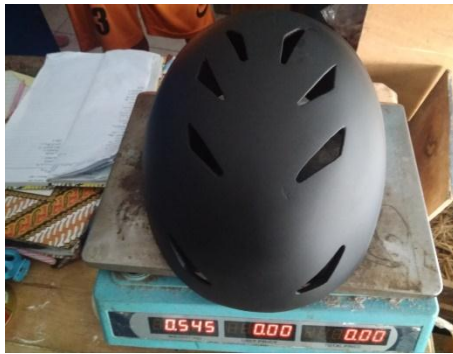
Gambar 4.3 Contoh Pengukuran berat dan tebal produk helm komposit alam
