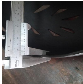
Gambar 4.3 Contoh Pengukuran berat dan tebal produk helm komposit alam
