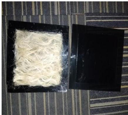
Gambar 3.22 Pemasangan Serat Sisal Pada Spesimen
