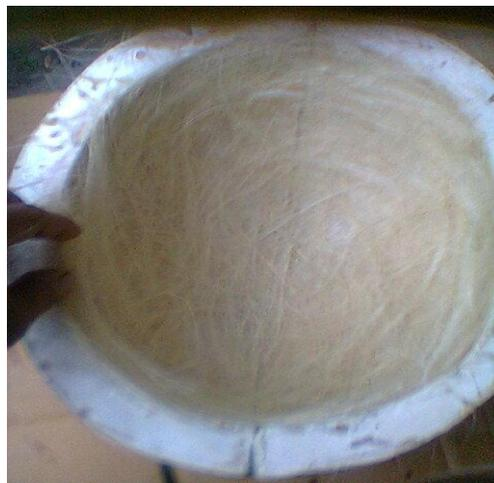
Gambar 3.27 Peletakan Serat Sisal Acak Pada Cetakan
