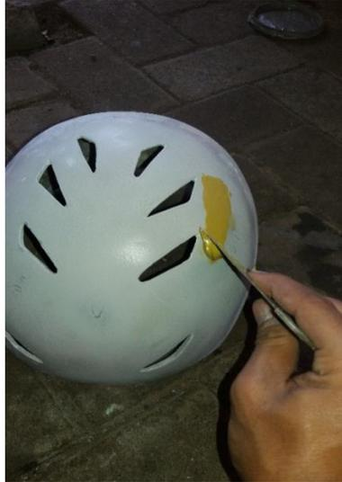
Gambar 3.33 Pendempulan Setelah *Epoxy*
