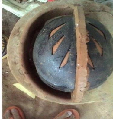
Gambar 3.12 Mengukur Ketebalan Cetakan Helm
