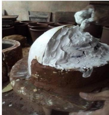
Gambar 3.15 Pemberian Gypsum Lapisan Cetakan 2
