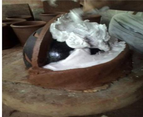
Gambar 3.14 Pemberian Gypsum Lapisan Cetakan 1
