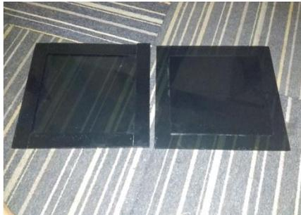
Gambar 3.20 Cetakan Spesimen
