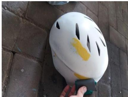
Gambar 3.34 Proses Pengamplasan Terakhir
