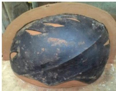
Gambar 3.11 Langkah Awal Pembuatan Cetakan Helm
