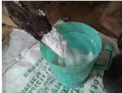
Gambar 3.13 Pencampuran Bahan Cetakan
