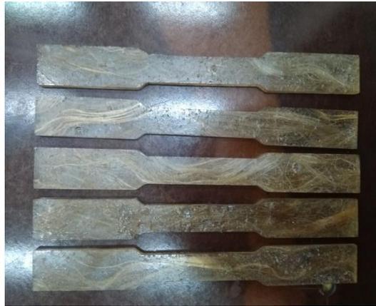
Gambar 3.24 Spesimen Uji
