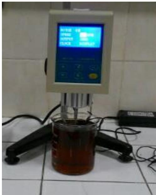
**Gambar 3.4.** Viskometer NDJ 8S
