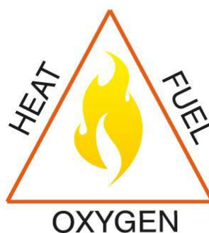
Gambar 2.6. Skema segitiga pembakaran sempurna ( http://fire-training.com.au , 2016)
