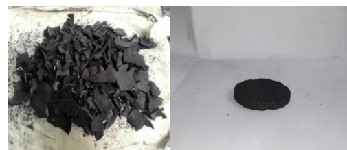
Gambar 3.1 Arang tempurung kelapa dan briket silinder pejal
