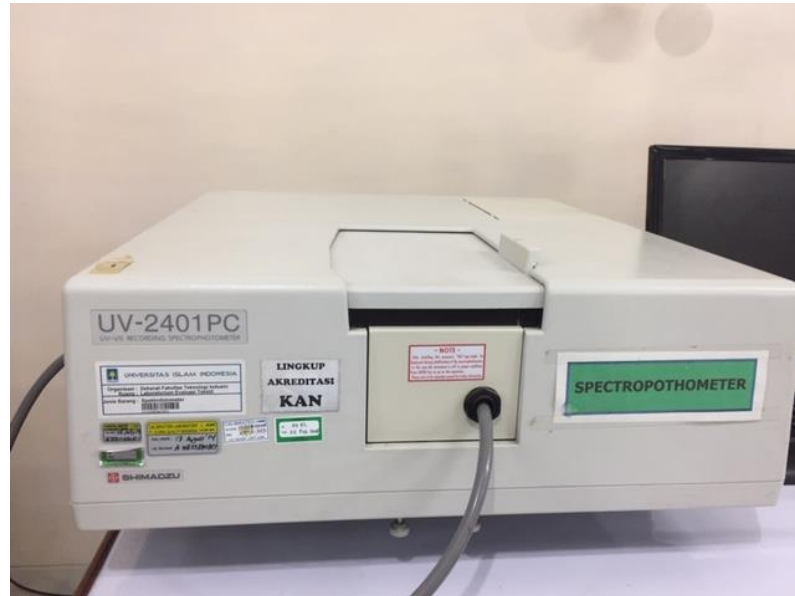
Spectrofotometri untuk pengukuran warna resin akrilik
