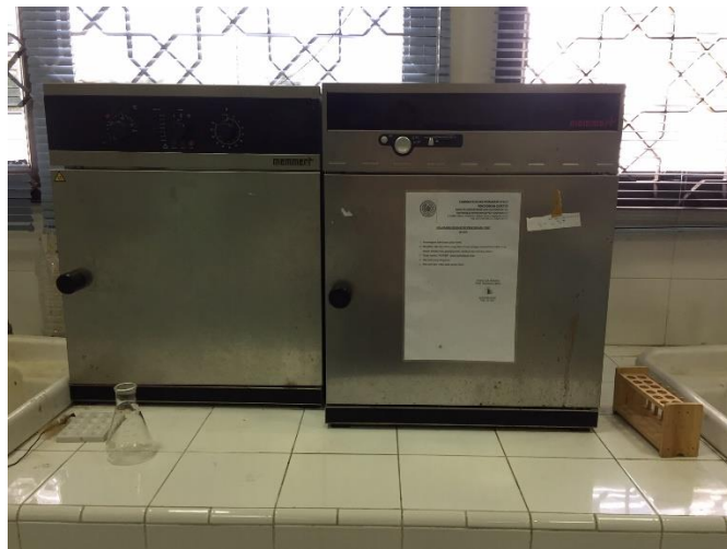
Inkubator tempat perendaman kayu manis dan kopi putih suhu 37 0 C
