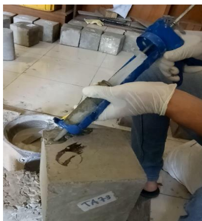
Gambar 3. 28 Proses penyuntikan bahan grouting
