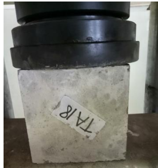
Gambar 3. 26 Pengujian kuat tekan kubus beton
