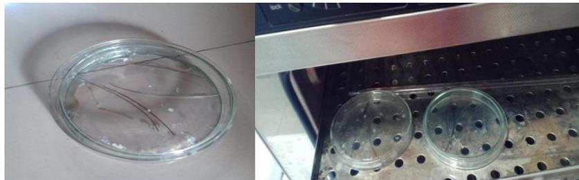
**Gambar 5.** Kawat di rendam dalam saliva buatan sebelum dimasukkan inkubator.
