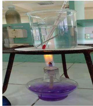
**Gambar 4.** Pererndaman kawat pada larutan suhu  $45^{\circ}\text{C}$ .
