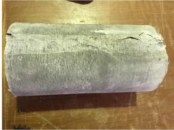
Gambar 4 Beton setelah dilakukan uji tarik belah.
