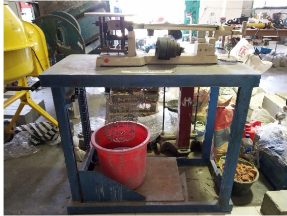
Gambar 4 Timbangan dalam air.
