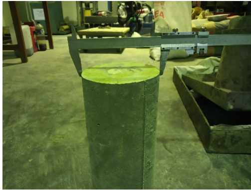
Gambar 1 Pengukuran diameter benda uji silinder.
