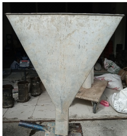
Gambar 3 Alat pengujian v-funnel .
