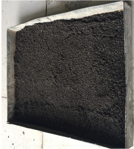
Gambar 4 Agregat halus (pasir progo).
