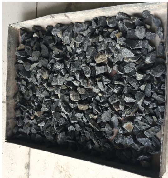
Gambar 3 Kerikil Agregat kasar (kerikil clereng).
