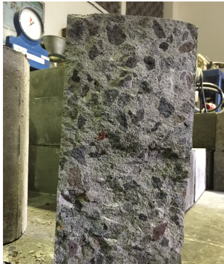
Gambar 5 Beton setelah dilakukan uji tarik belah pada benda uji normal.
