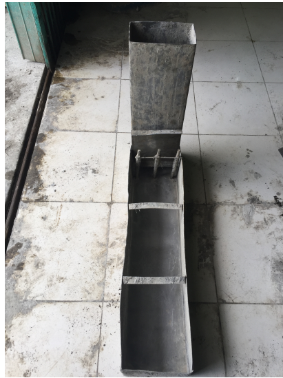
Gambar 4 Alat pengujian l-box .
