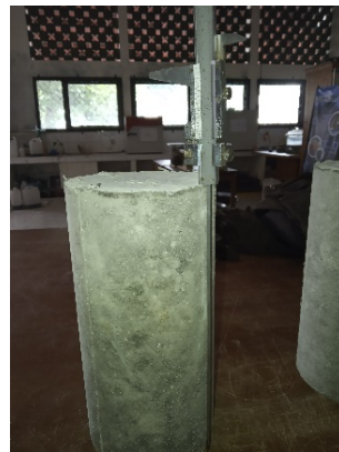
Gambar 2 Pengukuran tinggi benda uji silinder.
