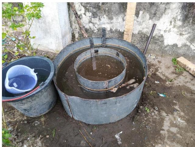
Gambar 3 Proses pembacaan penurunan air
