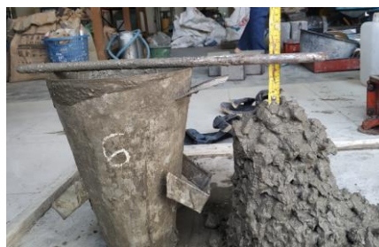
Gambar 4.1 Hasil slump test pada campuran beton
