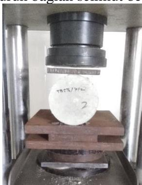
Gambar 1 Penempatan benda uji pada mesin uji tekan
