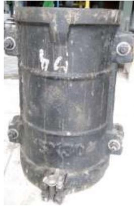
Gambar 3. 20 Cetakan benda uji.
