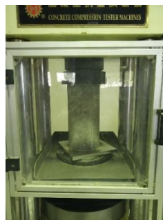
Gambar 30 Pengujian kuat tekan beton
