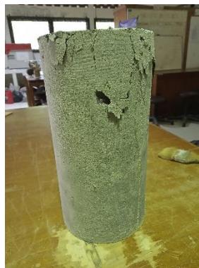
Gambar 31 Beton setelah dilakukan uji tekan
