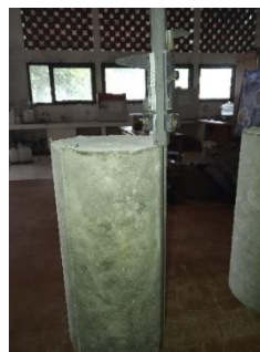
Gambar 29 Pengukuran tinggi benda uji silinder
