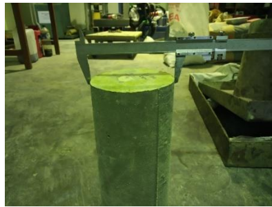
Gambar 28 Pengukuran diameter benda uji silinder
