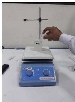
Gambar 3.3 Proses penuangan PVA kedalam aquades
