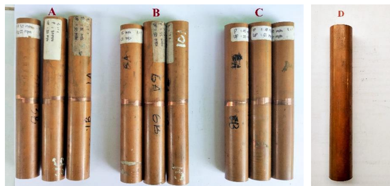
Gambar 4.10 Spesimen uji tarik, (A) 30 MPa, (B) 35 MPa, (C) 40 MPa, dan (D) Raw material tembaga
