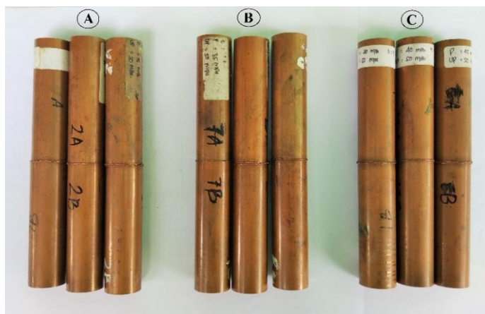
Gambar 4.1 Spesimen hasil pengelasan gesek dengan tekanan pada pipa tembaga ukuran 7/8": (A) 30 MPa, (B) 35 MPa, (C) 40 MPa
