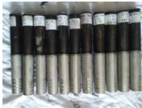
Gambar 4. Hasil Pengelasan gesek baja karbon dengan stainless steel
