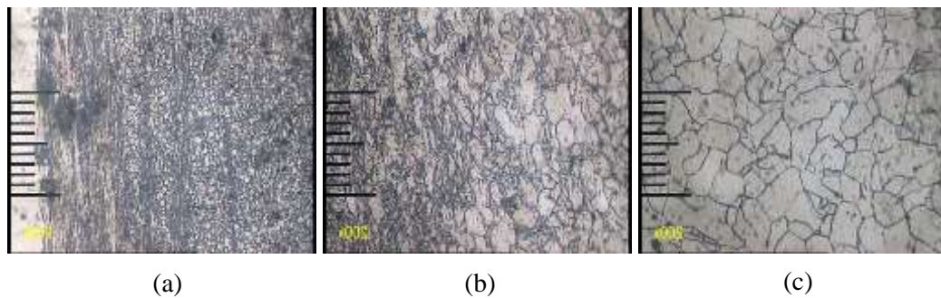
Gambar 4.8 Struktur Mikro Baja tekanan 35 MPa a. Daerah las b. Daerah terkena panas (HAZ) c. Daerah Logam Induk.
