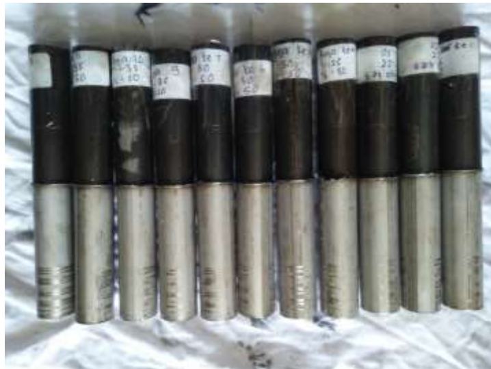
Gambar 4.1 Hasil pengelasan gesek baja dengan stainless steel.
